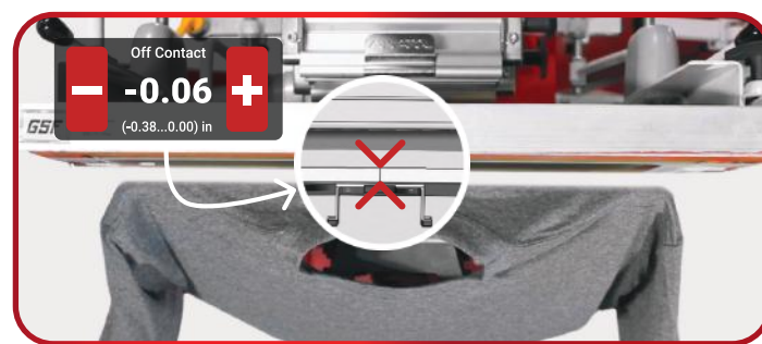
Цифровая регулировка off-contact с сенсорной панели управления
