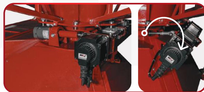
Высококачественный серво индекс для плавного, бесшумного вращения даже на самых высоких производственных скоростях, а также возможность свободного вращения вручную
