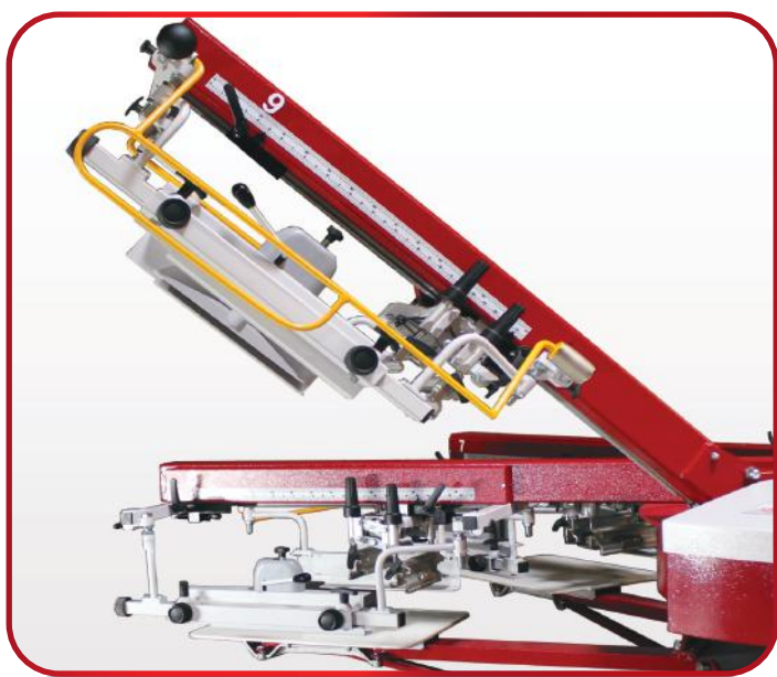
Функция поднятой печатной головки
